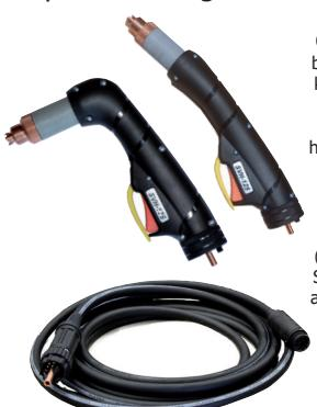
**Originální systém SV-FIT** umožňuje s malými náklady si využívat mezi různými těly hořáku (15, 75 nebo 90 stupňů), různými výkony (hořák SVH-105 ušetří spoustu tlakového vzduchu oproti hořáku SVH-125). Snadný odmontováním můžete hořák se standardní krátkou rukojetí nahradit hořákem s prodlouženou rukojetí dlouhou až 130 cm. Pořízením prodlužovacího kabelu můžete hořák snadno prodloužit o 6 m.
