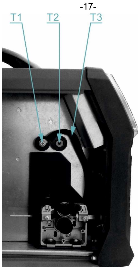
Obrázek 7 - Detail terminálů změny polarity MIG/MAG hořáku
