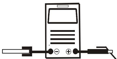
**Upozornění** Dávejte pozor, aby se elektroda nedotkla žádného kovového materiálu, protože v tomto režimu je při zapnutém stroji na rychlospojkách svařovacího stroje stále svařovací napětí.
