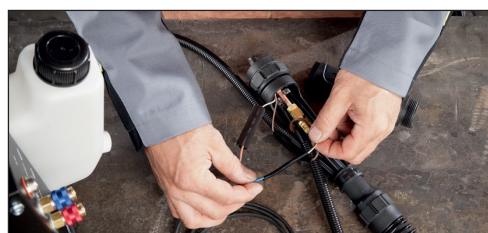
4. Zaizolujte spoje pomocí smršťovací bužírky.
