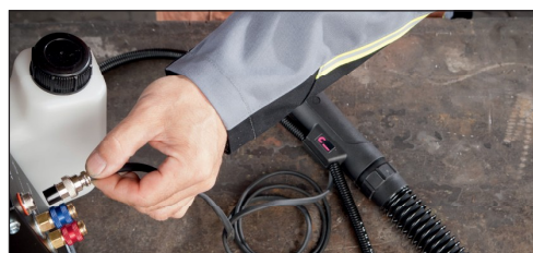
8. Zapojte kabel kontroly průtoku do chladicí jednotky.
